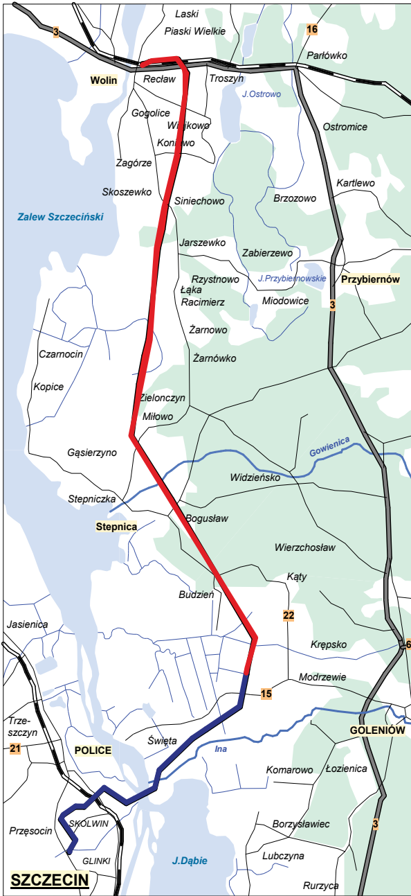
Mapa: proponowana trasa linii elektroenergetycznej 220 kV Glinki – Reclaw
